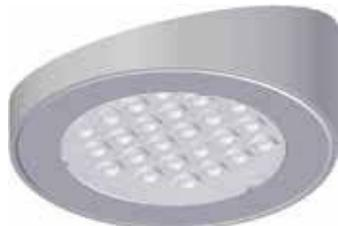
METRIS OB ist die ideale Aufbauleuchte mit LED-Technik, die überall dort zum Einsatz kommen kann, wo sonst Dreiecksleuchten eingesetzt würden. Das einfach zu montierende schräge Aufbaugehäuse ermöglicht auch ein Nachrüsten von bestehenden Schränken. Das Anschlusskabel ist 2000 mm lang und ist mit einer Micro12-Steckverbindung für LED-Konverter mit 12Vdc ausgerüstet.
